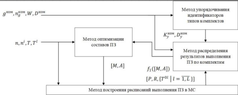
Рис. 1. Схема системы планирования выполнения ПЗ в МС при формировании комплектов в директивные сроки
